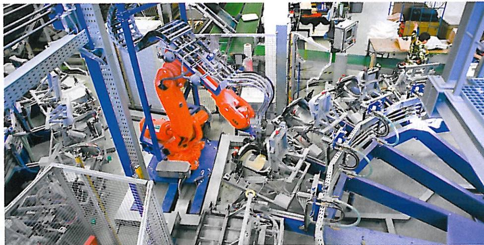
HIGHTECH: In der vollautomatischen Schaumanlage werden die Formschaumpolster für circa 950.000 Stühle pro Jahr gefertigt.
